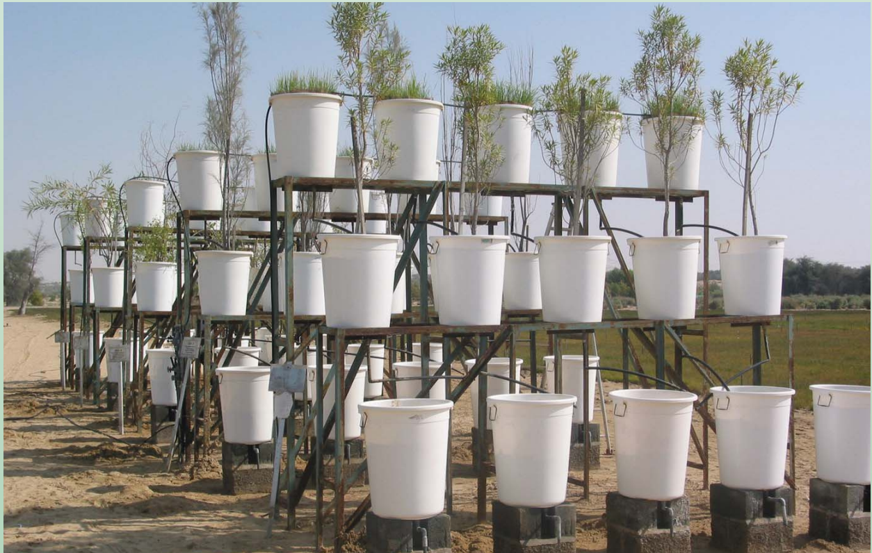
منظومة مقياس التخلل في مقر المركز الدولي للزراعة الملحية
