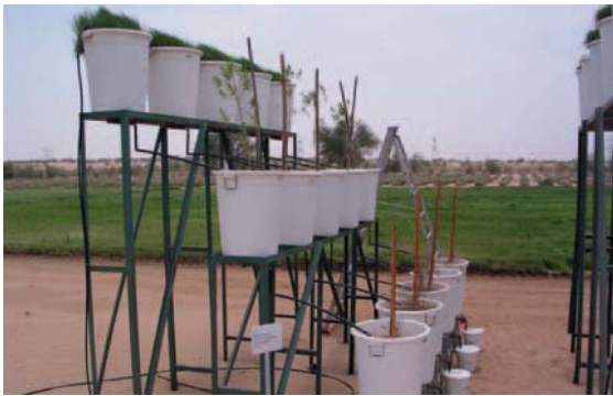
مقياس التخلل الثلاثي المتدرج لتحديد إمكانية استخدام مياه الصرف وتوازن الأملاح لأنواع مختلفة من الأعشاب والشجيرات
